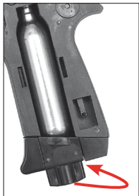
Avvitare fino alla battuta la vite di pressione della capsula.
